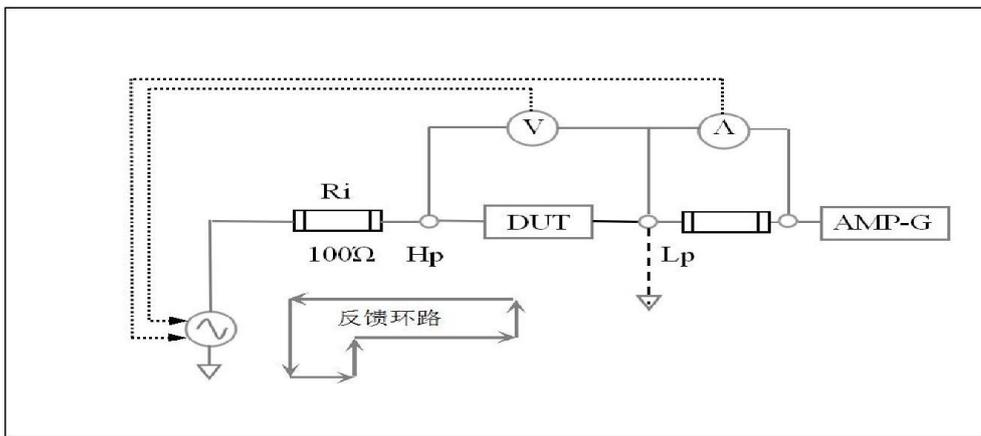
图 4-7 自动电平调整流程图
